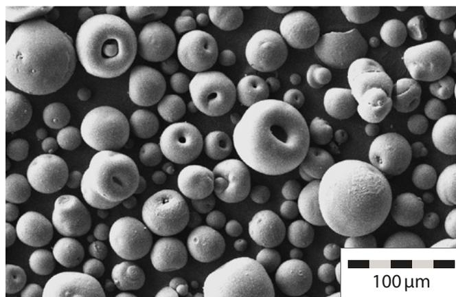
**FIGURE 8: POROSITY OF AEROPERL® 300 PHARMA**
